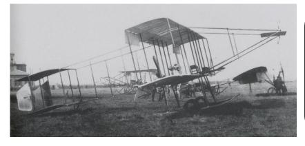
アンリ・ファルマン機 フランス製、1910年型。明治 44年4月5日早朝、所沢飛行場 で最初に飛んだ飛行機。 乗員2名、エンジン50HP×1 台(空冷回転式)、全幅10.5m、 全長12m、全備重量600kg、 最大速度65km/h。
