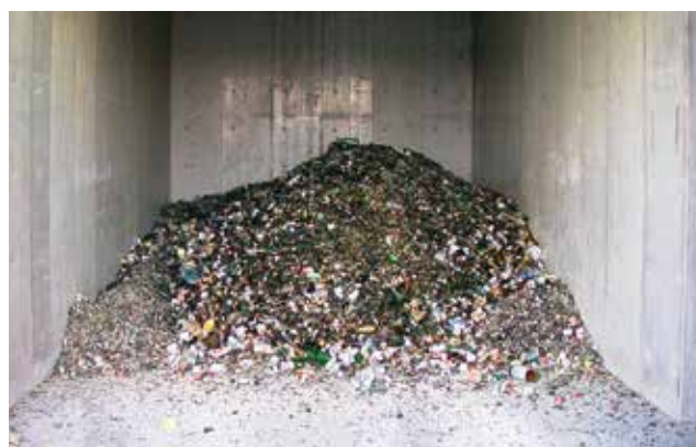
カレット貯留ヤード びん類を透明・茶・その他に分けて貯留します。
