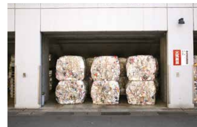
プラスチック減容物ヤード 圧縮梱包機でペール化された容器包装プラスチックを一時保管します。
