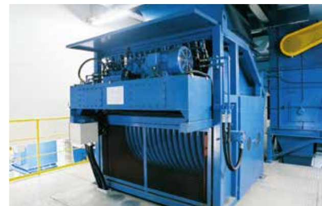
破袋機 ごみ袋を破り中身を取り出します。
