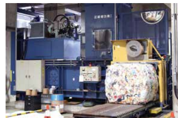
圧縮梱包機① (容器包装プラスチック用) 圧縮減容して再資源化します。
