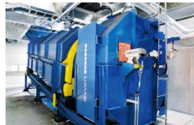
破碎物用選別機 破碎物を大きさ別に選別します。
