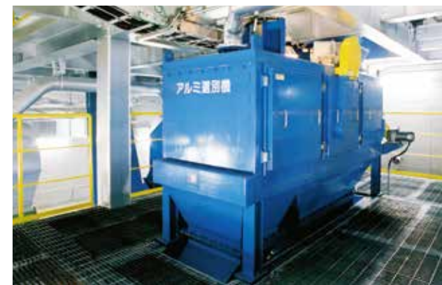
アルミ選別機 破碎物の中からアルミを選別します。
