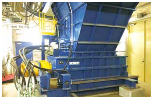
粗破碎機 粗大ごみを概ね30cm以下の大きさに破碎します。
