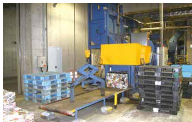
スチール缶プレス機 スチール缶を圧縮してコンパクトな塊にして再資源化します。
