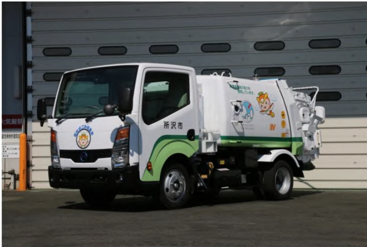
電気式ごみ収集車 (EV パッカー車)
