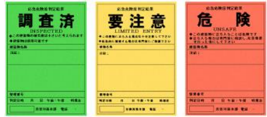
震災建築物応急危険度判定のステッカー
